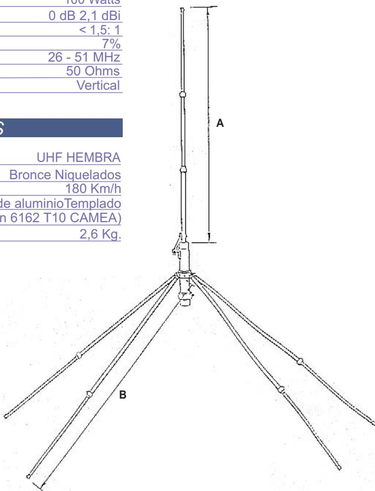
**ARMADO GENERAL:** Armar la antena de acuerdo a las medidas especificadas por frecuencia en la tabla adjunta.
